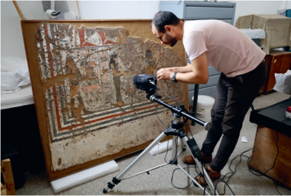
Abb. 13: pXRF-Analyse der Malerei vom Südteil der Fassade des Sanktuars durch Eid Mertah im Oktober 2022, © Wadi es-Sebua-Projekt 2022, Foto: Martina Ullmann.
