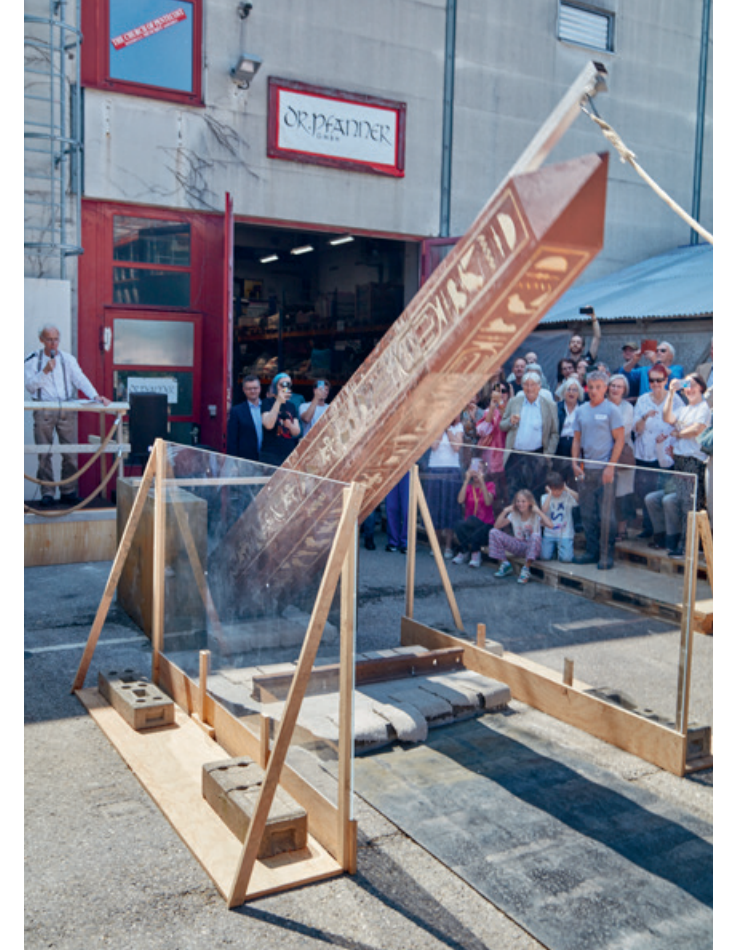
Abb. 2: Bild vom Umsturzversuch, © SMÄK, Foto: Roy Hessing.
